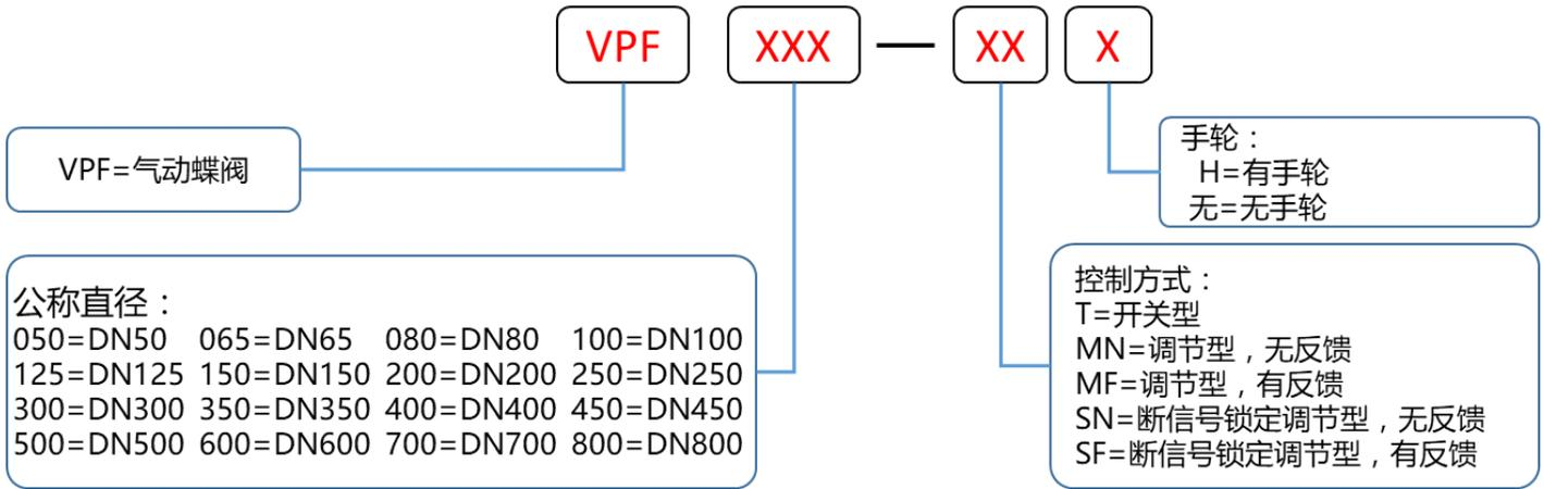
\*注：产品选型时，不需要单独进行执行器选型。全套产品的型号包含阀体、执行器和其他配套设备
